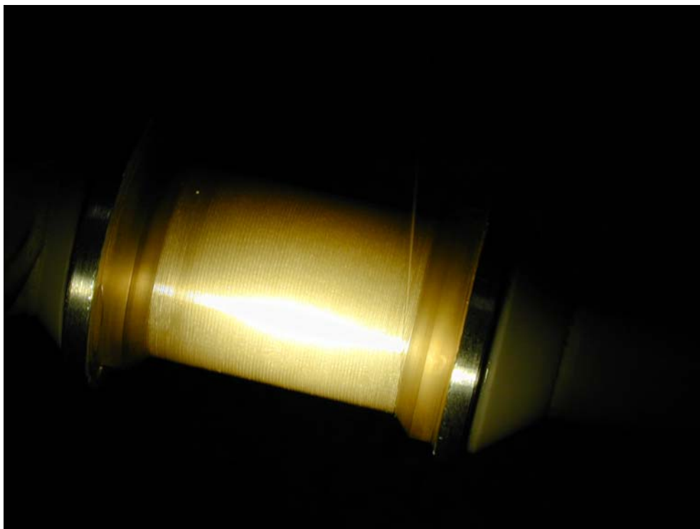
Рис. 12. Первый слой оптоволокна завершен.
