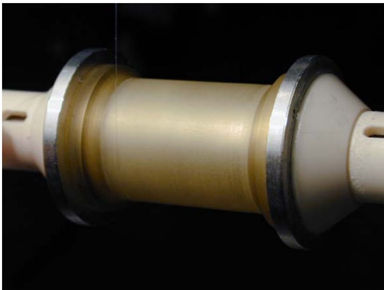
Рис. 10. Изображение основы гидрофона с несколькими витками оптического волокна. Из-за малого диаметра оптоволокна качество процедуры невозможно проконтролировать без микроскопа.
