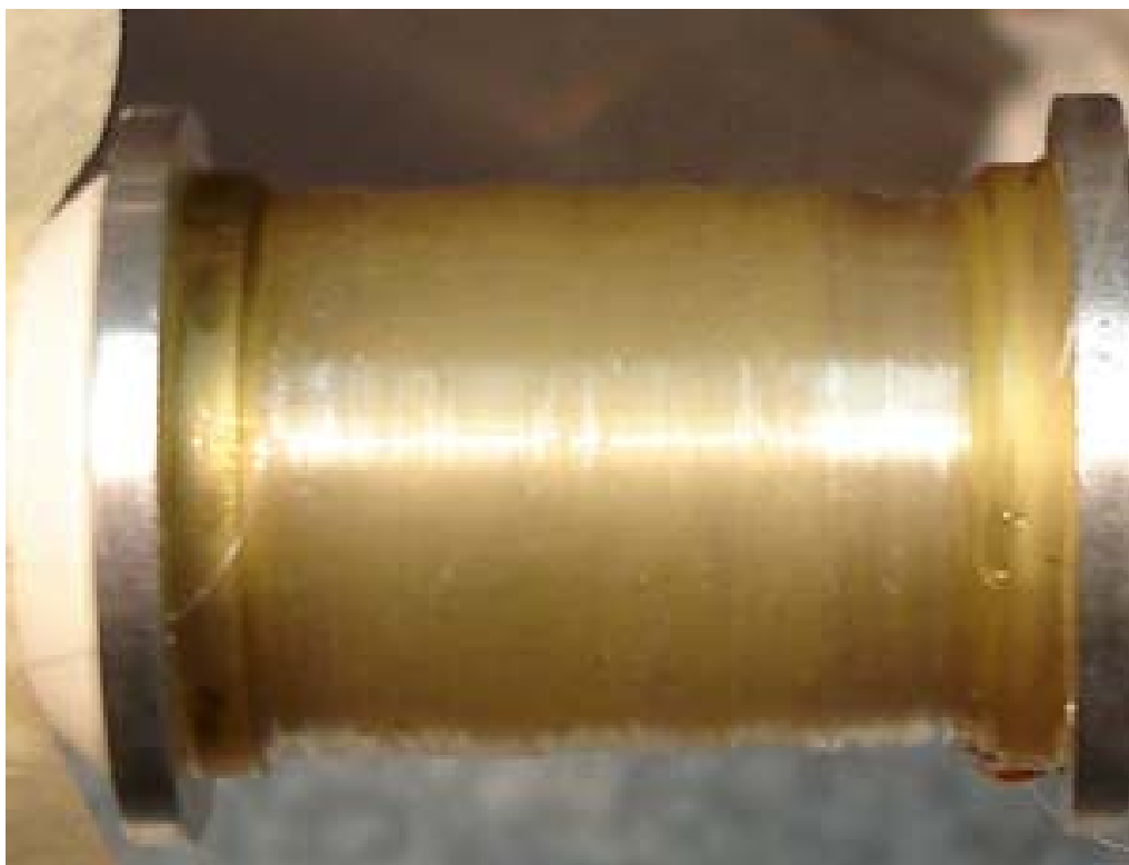
Рис. 13. Изображение завершенного гидрофона, содержащего 9 слоев оптического волокна.
