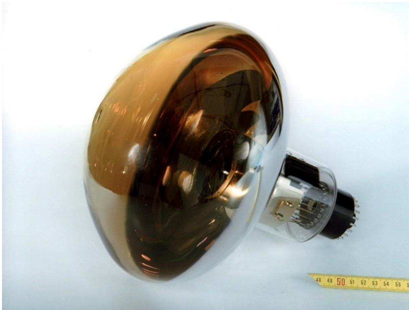
Рис. 10: Тестовый образец ФЭУ для проекта НЕМО.
