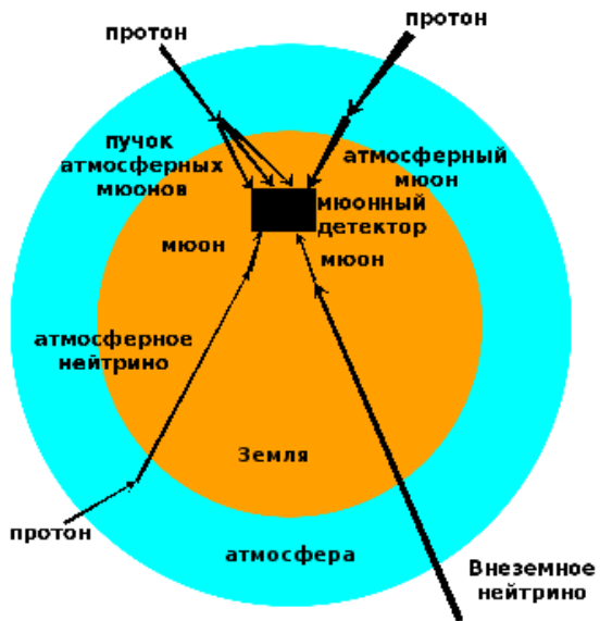
Рис. 3: Различные типы мюонов, попадающие в детектор, в зависимости от их происхождения. Голубым цветом изображена атмосфера Земли. Сама планета изображена оранжевым цветом. Детектор обозначен в виде чёрного прямоугольника, находящегося внутри Земли (в море). Информацию от внеземных источников несут только мюоны от внеземных нейтрино (изображено справа внизу). Все остальные мюоны представляют собой фон, для снижения которого используют различные методы.
